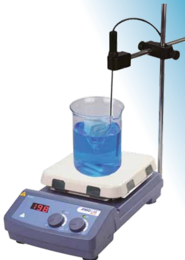
Agitatore M3-D con supporto regolabile e PT 1000
