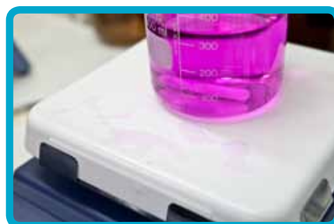
Piattello in vetroceramica a elevata resistenza chimica
